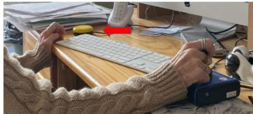
(exemple : joystick USB Point It Standard et utilisation d'un contacteur séparé pour l'action clic gauche)
