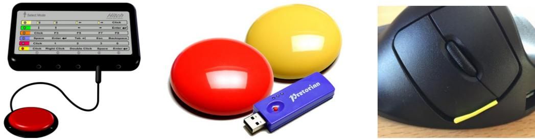
(Interface Hitch (solution filaire), contacteurs sans fils Smoothies, blocage mécanique d'un bouton clic)
