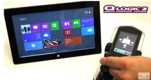
(Contrôle d'un ordinateur, smartphone, tablette par le joystick d'un fauteuil roulant électrique : ci-dessus R-Net Bluetooth Module et Q-Logic 2 Drive Control System)
